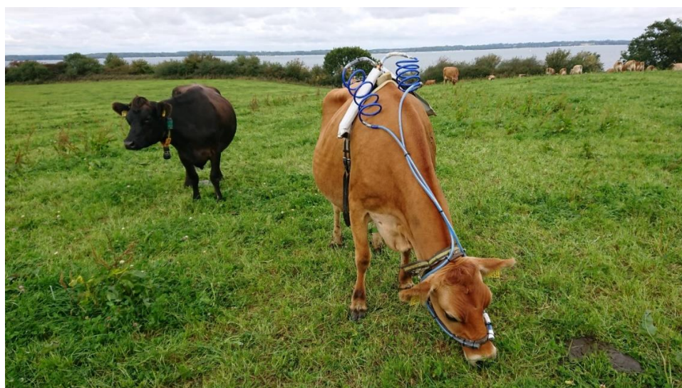
Fot. 1. Krowa rasy jersey z urządzeniem pomiarowym do badania emisji metanu podczas dobowej aktywności zwierzęcia w gospodarstwie Lindhof (Niemcy) – fot. Tomasz Sakowski. Większość tej emisji (ponad 95%) przypada na odłykanie.
